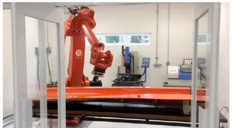
FIG. 2. ROBOT MANIPULADOR USADO EN CIDI PARA PROCESO DE MANUFACTURA DE PARTES INCLUYENDO CURVAS Y SUPERFICIES COMPLEJAS: SEGMENTO DE PALA DE AEROGENERADOR (FOTO CORTESÍA DE CIDI).
